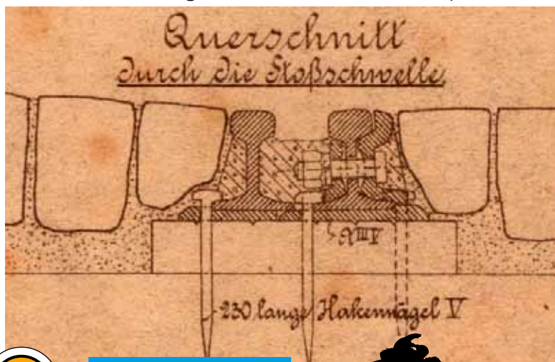
Abb.: Zeichnung zur Verwendung von Schienennägeln
